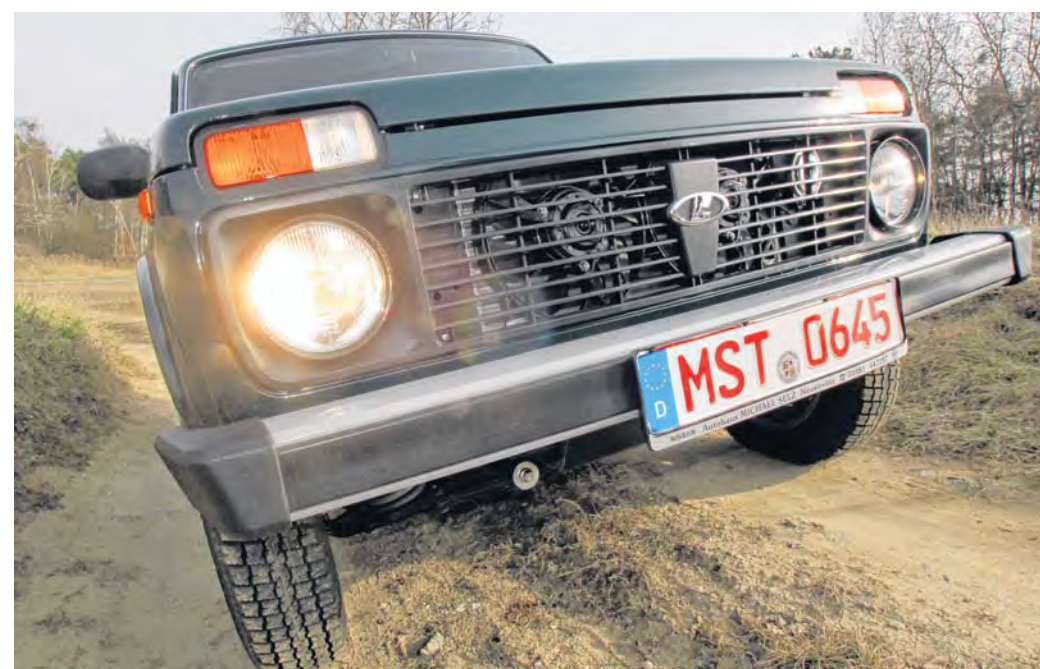
Klettermaxe: 58 Prozent Steigfähigkeit, 86 Zentimeter Wattiefe, 48 Grad Kippwinkel - in Offroad-Fachkreisen sind das Werte, die für Ehrfurcht sorgen.
